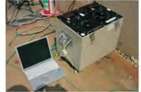
▲ 電圧 (電位) 降下法での接地抵抗測定
